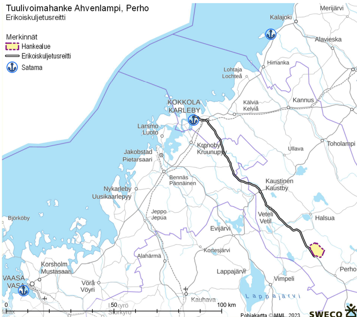
Kuva 39. Erikoiskuljetusten reitti Kokkolan satamasta hankealueelle. Mahdollisia muita satamia, johon tuulivoimaloiden osat voivat saapua, ovat Vaasa ja Kalajoki.
