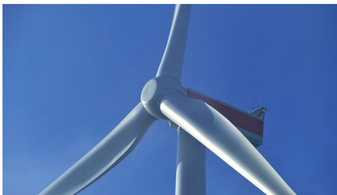
Kuva 21. Roottorin siipimateriaali vaikuttaa tuulivoimalan kierrätettävyyteen.
