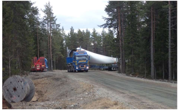
Kuva 91. Kuvapari. Vasemmalla: Esimerkki tuulivoimapuiston rakennus- ja huoltotiestä. Maakaapeli sijoitetaan ojakaivantoon tien reuna-alueelle. Oikealla: Tuulivoimalan osia kuljetetaan erikoiskuljetuksina. (Kuvat: FCG).
